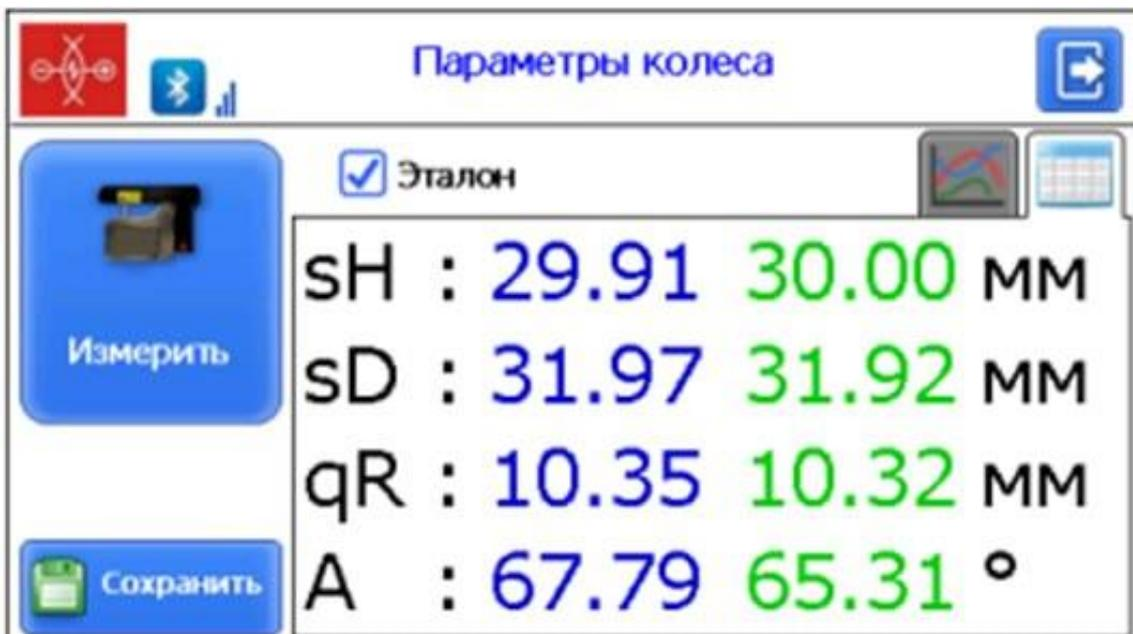
Замеры показываемые при измерении в кпк(есть возможность настроить показываемые параметры)
