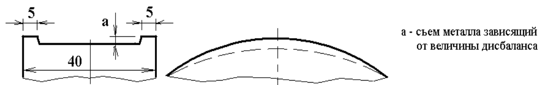
Рис. 15.1 Проточка на венце тормозного диска для устранения дисбаланса
